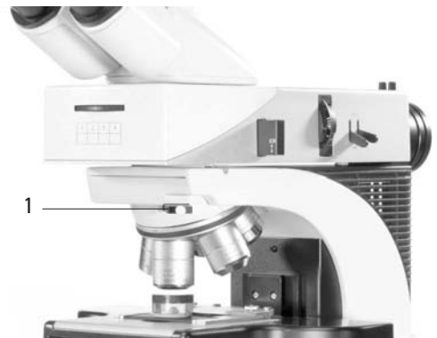
Abb. 57 Objektivprisma mit Stellschraube
