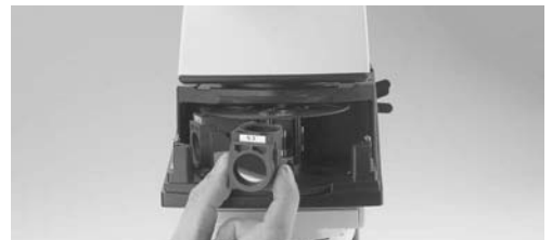
Abb. 22 Einsetzen des Filterwürfels
