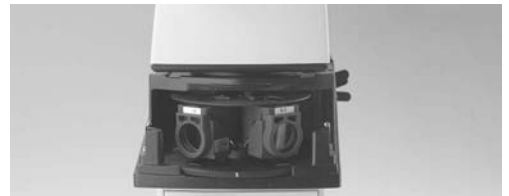
Abb. 21 Aufsicht-/Fluoreszenzachse ohne Frontabdeckung
